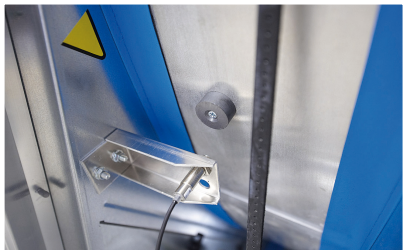
Rotorlaufkontrolle im Rotorgehäuse
