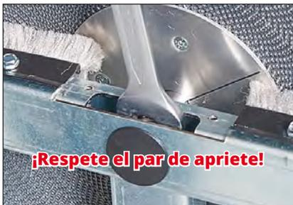
(10) Una vez ajustado el recuperador a la inclinación adecuada, se fija la posición apretando el tornillo de cabeza hexagonal (para el par de apriete adecuado, véase la tab. 2).
