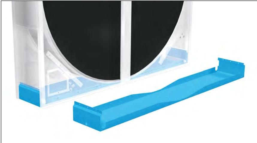
Para recoger el condensado o el líquido de limpieza en la parte inferior de la carcasa y drenarlo fuera de la unidad de tratamiento de aire, se puede instalar una bandeja de condensado (ver tab. 3, página 13) de aleación de aluminio resistente a la corrosión. Para evitar daños en el transporte, el desagüe está a ras de la carcasa. La conexión in situ puede realizarse a través de la rosca interna de 3/4".
