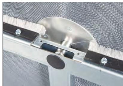
Retire la junta de la escobilla y la tapa de los rodamientos
