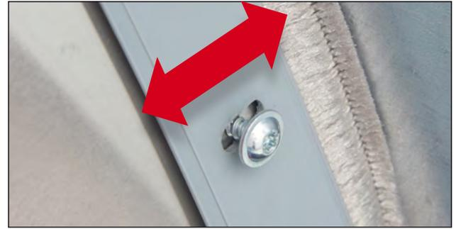
El sellado periférico se puede ajustar mediante un orificio ranurado en el soporte de la junta en la masa de almacenamiento. De este modo, se consigue una estanqueidad óptima entre la masa de almacenamiento y la carcasa.
