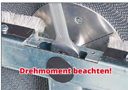
(10) Una vez ajustada la rueda de calor a la inclinación adecuada, se fija la posición apretando el tornillo de cabeza hexagonal (para el par de apriete, véase la tab. 2).
