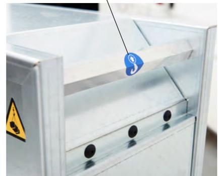
Levante la carcasa solo por las dos esquinas superiores utilizando los perfiles hexagonales allí previstos. **A**.
