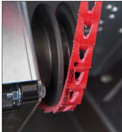
*Al montar la correa de transmisión, preste atención al sentido de giro de la masa de almacenamiento. El sentido de la marcha está marcado en los elementos de la cinta con una flecha*
