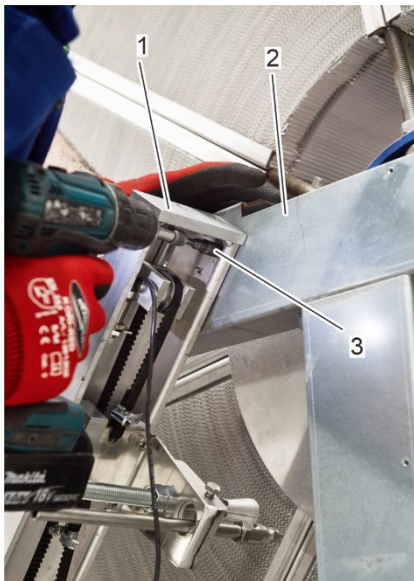
Abbildung 31: Befestigung der Reinigungsschiene
