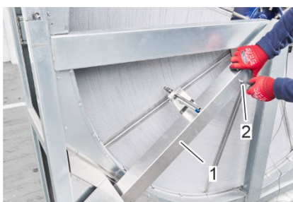
Abbildung 56: Befestigung der Abdeckung der Reinigungsschiene
