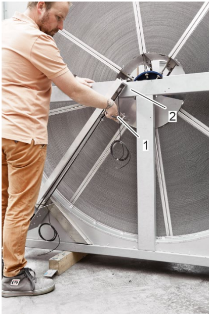
Abbildung 36: Obere Position des Reinigungsschlittens
