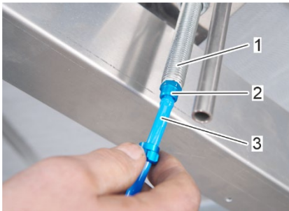
Abbildung 61: Druckluftschlauch in Druckluftdüse schieben
