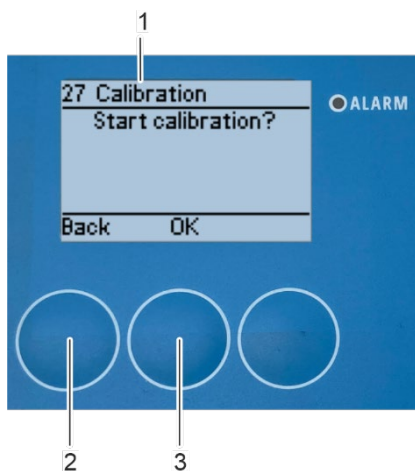
Abbildung 138: Durchführung einer Kalibrierung
