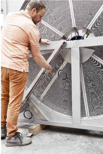
Abbildung 47: Mittlere Position des Reinigungsschlittens
