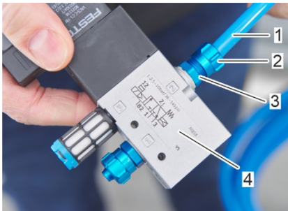
Abbildung 65: Sicherung Sie den Druckluftschlauch am Anschluss 2
